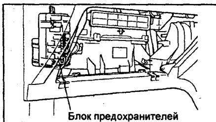
Расположение блока предохранителей в салоне автомобиля.
