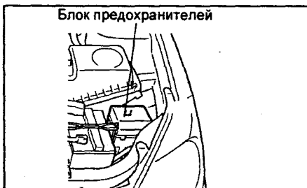
Расположение блока предохранителей в моторном отсеке.
